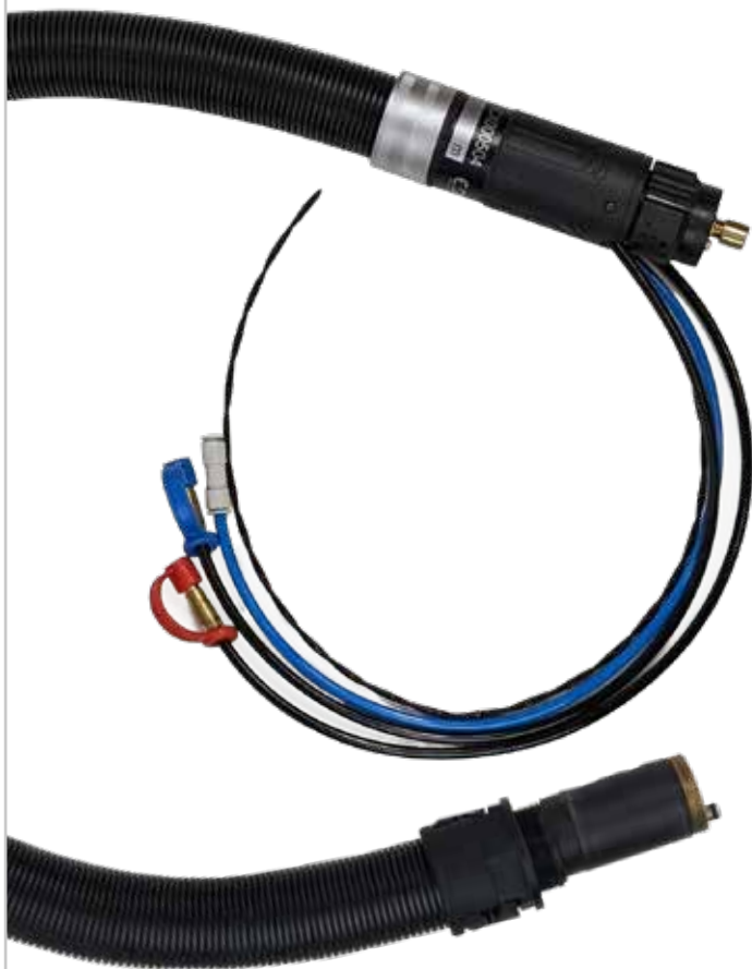
Se muestra artículo con refrigeración líquida. El modelo de gas es exteriormente idéntico exceptuando los conductos azul y rojo correspondientes al líquido refrigerante.
