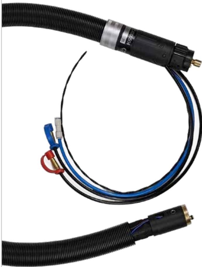
Se muestra artículo con refrigeración líquida. El modelo de gas es exteriormente idéntico exceptuando los conductos azul y rojo correspondientes al líquido refrigerante.
